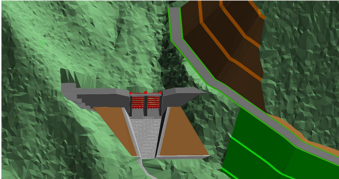
CIMで作成した砂防堰堤の全景図(ピーシーレールウェイコンサルタント)
