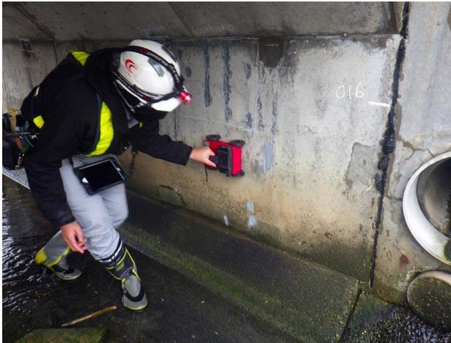
電磁波レーダーを用いたコンクリート構造物内部の点検(長大テック)
