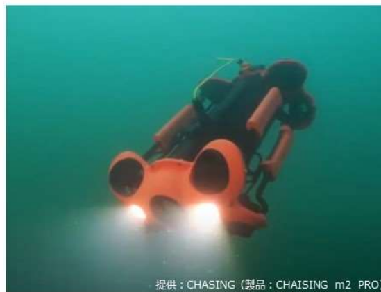
水中ドローンを用いた水中涵渠内の調査(長大)
