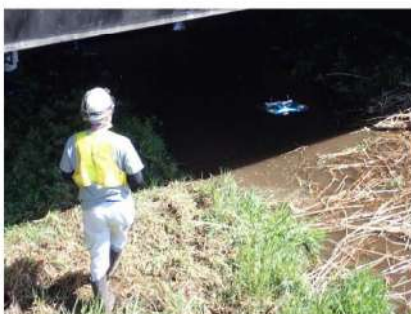
ドローンで橋桁を撮影し、画像データを解析
