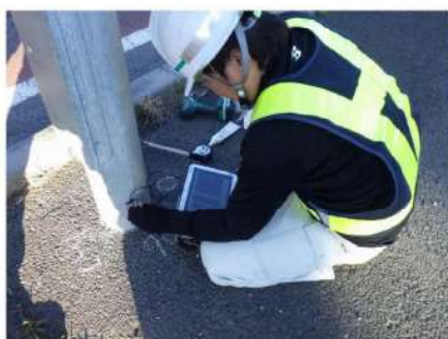
専用の装置を使って地際部を診断
