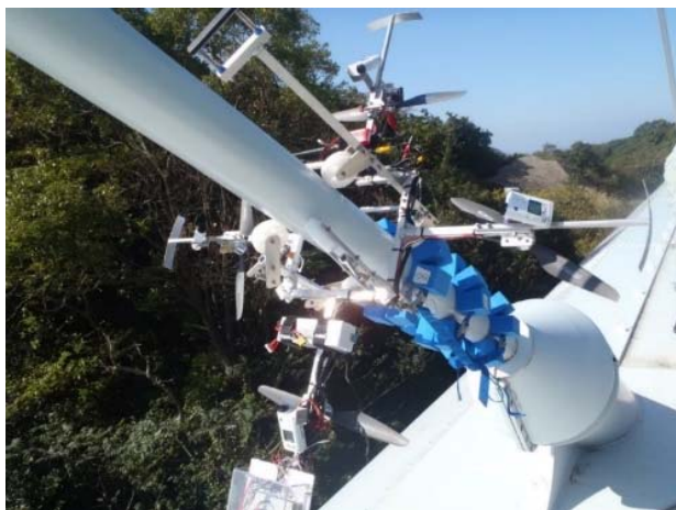
斜張橋ケーブル点検ロボット「VESPINAE」
